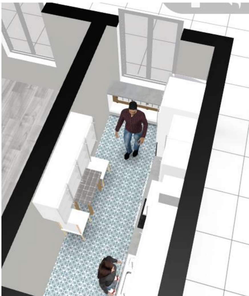
Zabudowa grzejnika pod oknem szafki otwarte wraz z blatem który połączony jest z parapetem
